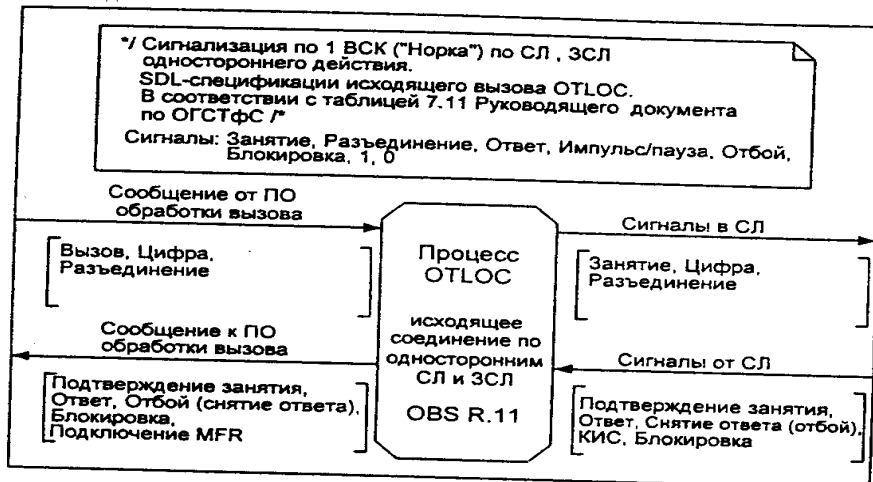
Рис. 7.2. Блок обработки исходящего вызова OTLOC OBS R.11
