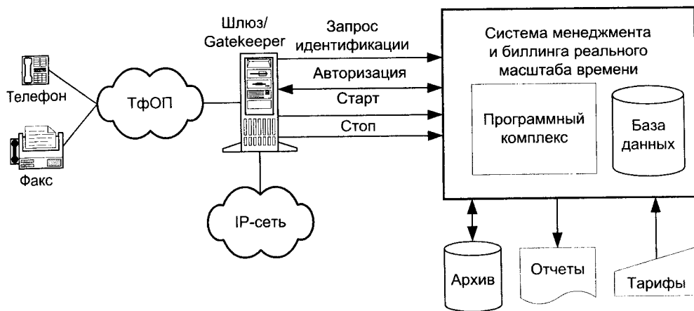
Рис. 7.2. Обслуживание вызова IP-телефонии при использовании комплексной системы биллинга и менеджмента реального масштаба времени
