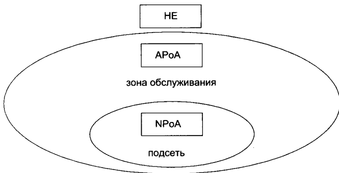
Рис. 9.1. Функциональные элементы, вовлеченные в обслуживание абонента при мобильности
